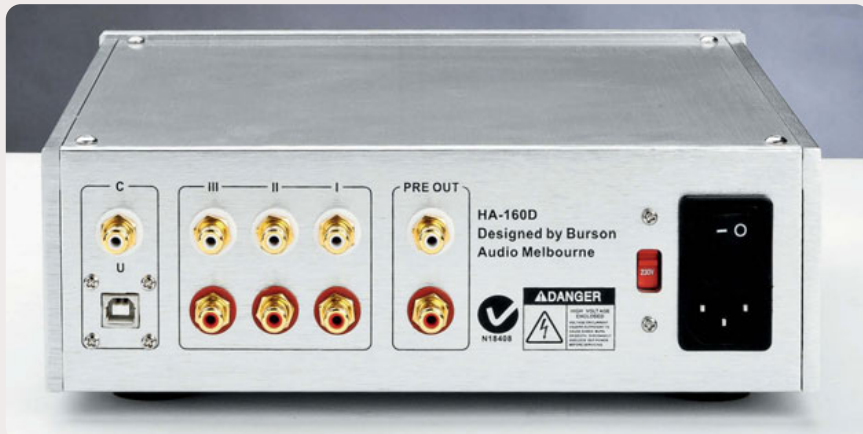
Tre ingressi analogici e due digitali sul retro. Buona la qualità dei connettori.
