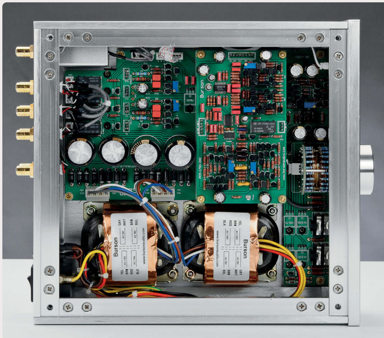
Le alimentazioni passano da due eccellenti trasformatori R-core e da una massiccia capacità di filtraggio. Notare anche il controllo del volume a rete di resistenze.
